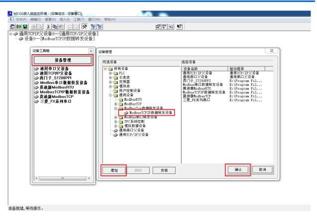
第二步,设置"通用 TCP/IP 父设备"属性,双击"通用 TCPIP 父设备 0-[通用 TCP/IP 父设备]"打开属性编辑窗口,设置按如下配置。其中触摸屏的 IP 地址可根据实际需要进行修改,此处记住触摸屏设置的 IP 地址和端口号,后面设置平台参数时会用到。
