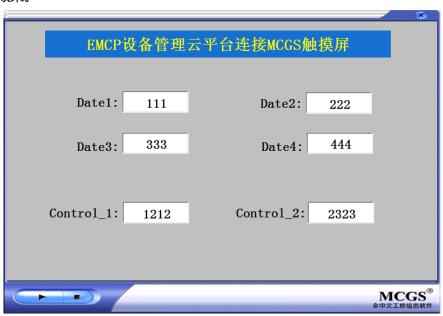
用户登录 EMCP 平台(www.lfemcp.com),点击【MCGS 触摸屏】设备的图片或设备名称进入设备。首先看到的是 MCGS 触摸屏定时采集数据的显示(实时数据),通过点击【读写数据】对 MCGS 触摸屏内部的数据进行读写。点击【历史数据】查看设备定时存储数据的历史数据报表,点击【报警记录】进入报警信息记录报表页面,显示如下。
